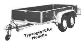
25 verschiedene Modelle ● Gesamtgewichte von 450 bis 2000 kg ● Alu-Chassis ● Siebdruckboden ● mehrfachverleimtes Birkensperrholz mit Allwetter-Belag ● 1- und 2-Achs-Anhänger ● Bereifung 175-14 ● Rückfahrautomatik ● div. Bordwandhöhen mit und ohne Blache.
