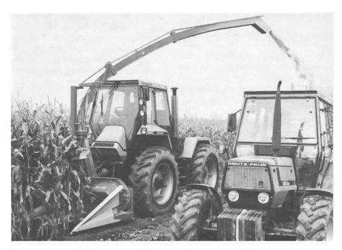
Der neue Intrac bietet als Frontsitztraktor eine sehr gute Sicht auf die Frontgeräte und braucht für geschobene Maschinen keine aufwendige Rückfahrvorrichtung.
