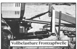
vollbelastbaren Zapfwellen mit wahlweise 540 oder 1000/min kann er in einem Arbeitsgang mähen und laden oder schwaden
