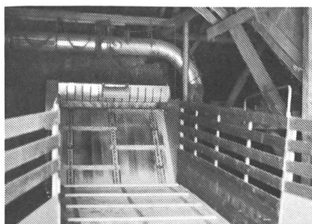
Abb. 3: Das Dosiergerät übernimmt die Arbeit der Gebläsebeschickung, und der Ladewagen wird ebenfalls nach der Schnellentleerung frei. Eine Hilfsperson sollte aber aus Sicherheitsgründen (Unfallschutz) die Maschinen überwachen.
