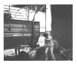
Abb. 1: Das Beschicken des Fördergebläses von Hand wird umso mühsamer, je feuchter das Futter eingeführt wird. Zudem bleibt der Ladewagen für die Zeit der Zuteilentleerung blokkiert.
