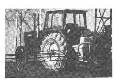
Tecnoma Feldbaugerät mit Girojet-Rotationsdüsen.
