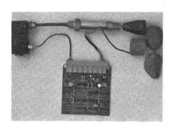
2 Diese Abbildung zeigt die Einzelkomponenten eines Kartoffelrodegerätes mit automatischer Steinabsonderung. Sensoren können feststellen,
