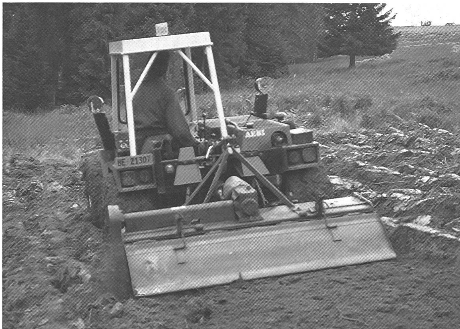
5 Zweiachsmäher mit Bodenfräse. Maschinen dieser Art erreichen ihre Einsatzgrenze bei 70% Steigung.
