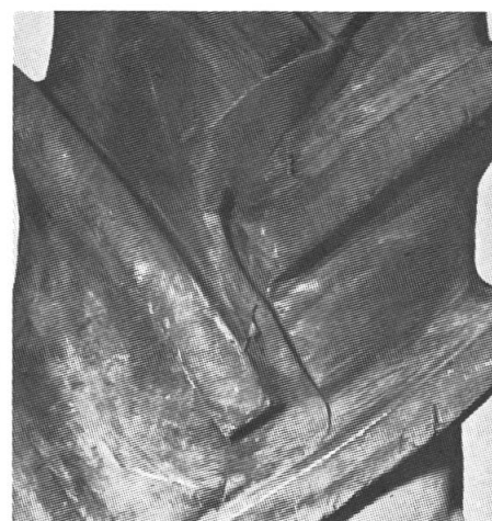
3 Laufflächenbruch durch Anprall.
