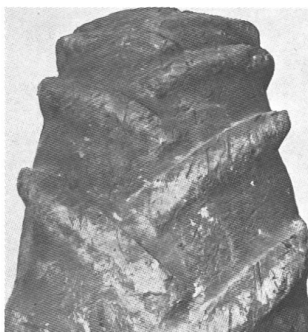
2 Zahlreiche, dicht beieinanderliegende Laufflächenschnitte.
