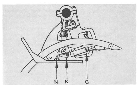
Bei der Probebindung darauf achten, dass das Garn straff über Nase N und Knüpferhaken K gespannt ist und genau in den Garnhalter G eingelegt wird.
