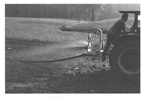
Mit dem Güllenverteiler mit Prallteller kann eine gute Verteilung erzielt werden. Durch den einfachen Bau ist der Preis dieses Verteilers entsprechend niedrig. Die Arbeitsbreite beträgt 8 bis 9 Meter.
