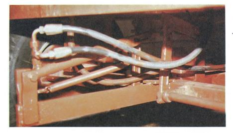
◄ Hydraulische Bremsen und elektrische Schluss-Blinkanlagen bieten mehr Sicherheit. Neue Traktoren sollen im Hinblick auf die Nachrüstung der Anhänger mit einem Anhängerbremsventil ausgerüstet sein.
