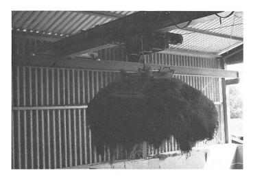
Abb. 2: Einlagerung mit Greifer. Eine sorgfältige Bedienung ist vorteilhaft. Das Nachverteilen von Hand ist die Regel.
