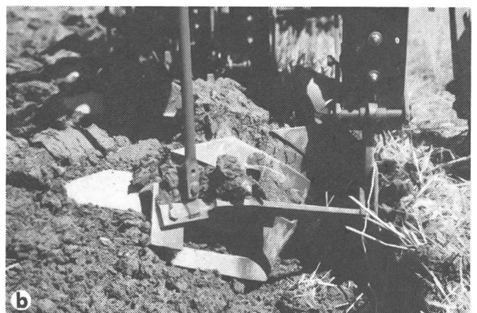
Abb. 5: Beim Streifen- (a) und Schlitzriester (b) werden die Einzelteile durch erhöhten Druck vermehrt und ungleichmässig belastet.
