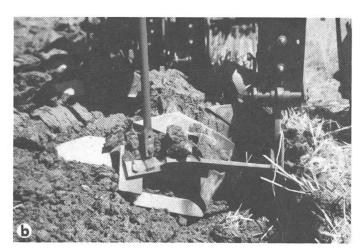
Abb. 5: Beim Streifen- (a) und Schlitzriester (b) werden die Einzelteile durch erhöhten Druck vermehrt und ungleichmässig belastet.
