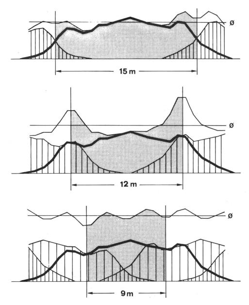
Abb. 2: Die Darstellungen, denen dreimal das gleiche Streubild zu Grunde liegt, zeigen, wie sich eine Änderung der Arbeitsbreite auf die Streugenauigkeit und die Hektargabe auswirken kann. Im gewählten Beispiel wird der Dünger bei 12 m Arbeitsbreite weniger gleichmässig als bei 9 m und 15 m verteilt.
