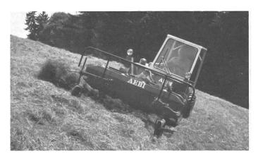
3 Ein Zweiachsmäher muss vielseitig eingesetzt werden können. In steilen und unausgeglichenen Hängen kommt zum Schwaden nur noch der Bandrechen in Frage. Der Kreiselschwader ist höchstens bis zur Einsatzgrenze des Traktors verwendbar.
