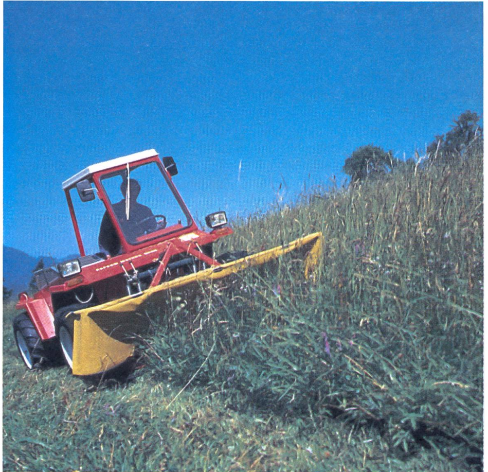
1 Bei der Anschaffung eines Zweiachsmähers steht die Wahl des Mähwerkes im Vordergrund. Scheibenmähwerke sind bei neueren Fahrzeugen noch gut ein Drittel schwerer als Balkenmäher. Der Leistungsbedarf ist höher, der Wartungsaufwand ist aber wesentlich geringer.
