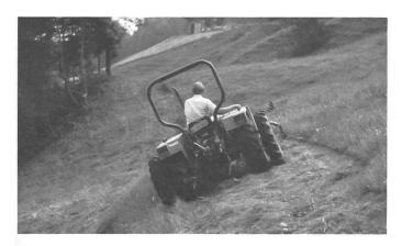
2 Auch abgeänderte Kleintraktoren sind recht hangtauglich, wenn sie vorne mit Terrareifen und hinten mit Doppelbereifung ausgerüstet werden. Wenn beim Anmähen in der Schichtlinie nicht zuviel Futter überfahren werden soll, muss der Mähbalken mindestens 20 cm breiter sein als die Gesamtbreite – über die Reifen gemessen.
