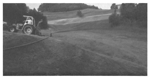
4 Der Zweiachsmäher wird heute nicht nur für die Futterernte eingesetzt. Kleintransporte mit der Ladepritsche oder die Gülleverschlauchung sind weitere interessante Möglichkeiten.
