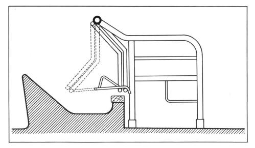
Abb. 4: Pendeleinsperrfressgitter gekröpft.
