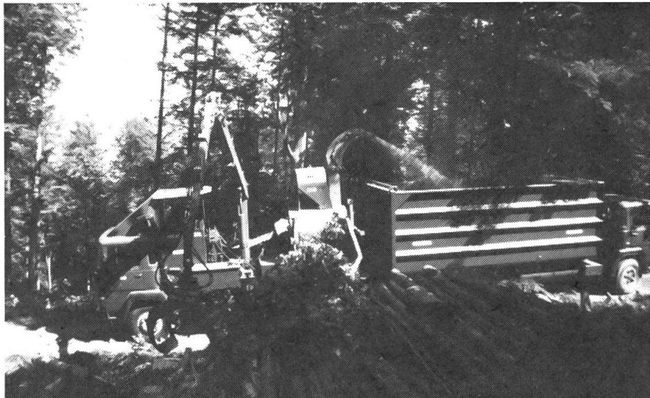
*Obwohl die Nutzung von Holz zur Äthanolherstellung technisch möglich ist, wird in den nächsten Jahren die Verwendung von «Energieholz» zu Heizzwecken im Vordergrund stehen. Durch die Aufbereitung zu Hackschnitzeln lässt sich eine rationelle Verwertung von Holz minderer Qualität realisieren.*
