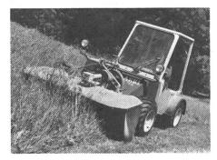
Zweiachsmäher Aebi Terratrac TT 33 mit Rotormäher und 27 PS Kubota-Dieselmotor.
