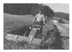
Aebi Eingrasmäher AM 41 mit Bandmahdenformer.
