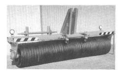
Auch die nachfolgenden Arbeitsgänge, wie spritzen, hacken, vereinzeln etc. können besser ausgeführt werden. Nach der Frühjahrs-Saat, ja selbst in steinigen Böden, ergibt sich eine vorzügliche Arbeit. Dasselbe Gerät wird mit bestem Erfolg auch als Wiesenwalze eingesetzt, wodurch ein vielseitiger Einsatz vom frühen Frühling bis zum späten Herbst gewährleistet ist.
