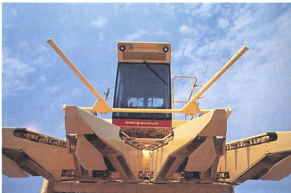
Für mehrreihige Maisgebisse bewährte sich nur der Zwangseinzug mit Gummiwellbändern oder Ketten. Zwangsförderung ist aber nur gewährleistet, wenn die Maisstengel schon vor dem Schnitt von den Transportorganen erfasst werden.
