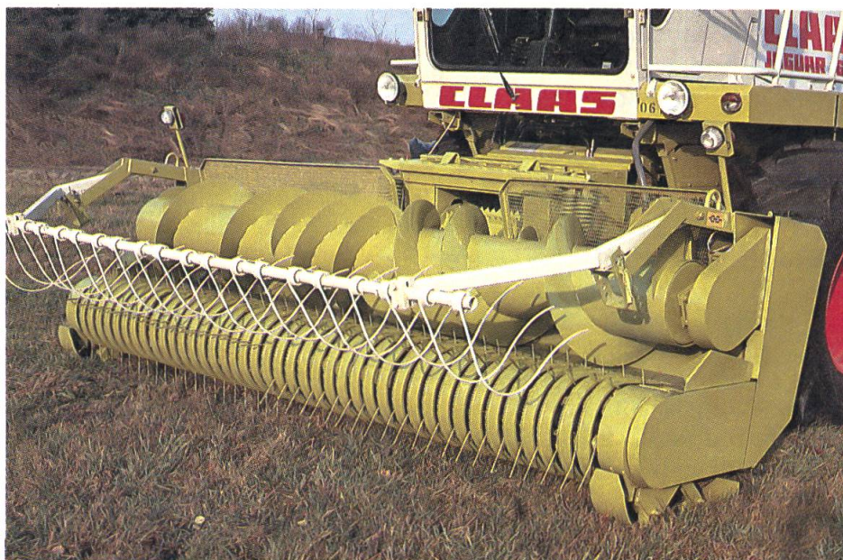
Die Pickup-Breite sollte nicht weniger als 2 m betragen, damit auch schlecht geformte Schwaden sauber aufgenommen werden.
