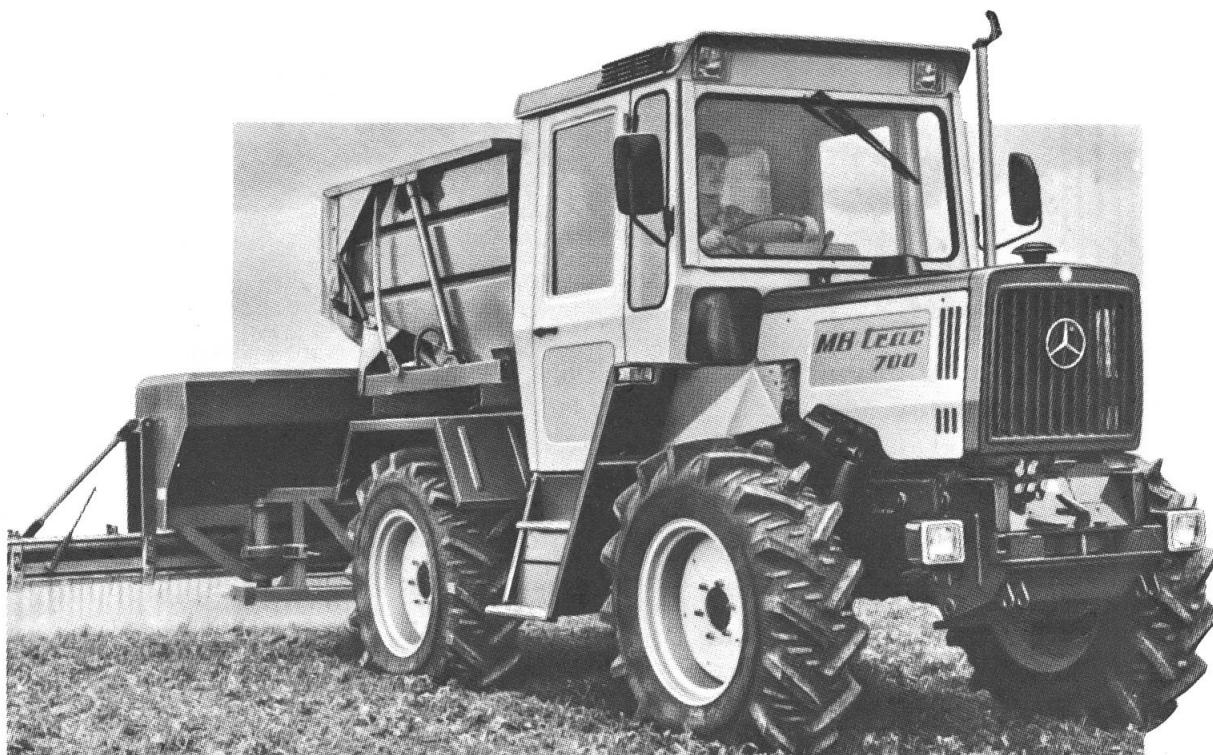
Wenn im Frühjahr unter Zeitdruck gearbeitet wird, sind die Qualitäten eines Schleppers entscheidend. Deshalb hat der MB-trac einen echten Allradantrieb mit zwei gleich starken Achsen, 100% ig wirkenden Kluendiffe-
