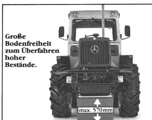
rentialsperren und vier gleich großen Rädern. Ein fein abgestuftes Getriebe mit Komfortschaltung, das immer die richtige Arbeitsgeschwindigkeit ermöglicht. Dies alles und eine optimale Gewichtsverteilung garantieren eine Bodenschonung, die selbst bei hohen Zuladungen kaum zu übertreffen ist. Bedenkt man noch seine hohe Bodenfreiheit, die Geräteanbaumöglichkeiten und die Großraum-Komfortkabine, lässt der MB-trac keinen Wunsch offen. Die MB-trac gibt es von 48–110 kW (65–150 PS).
