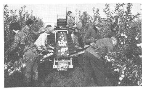
1 Die in Holland entwickelte Maschine für die Tafelapfelernte «Pluk-o-trak» steht speziell in Frankreich im Einsatz. Sie bringt vor allem eine Arbeitserleichterung, aber unter schweizerischen Verhältnissen mit zwei bis drei Erntegängen keine wesentliche Leistungssteigerung. Zudem müssen für eine genügende Auslastung gegen 20 ha Obstanlage geerntet werden können.
