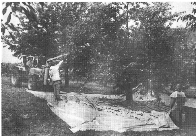
3 Der dänische Schüttler Schaumann im Einsatz bei der Brennkirschenernte. Die Bäume werden astweise geschüttelt.
