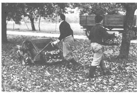
2 In Hochstamm-Mostobstbeständen hat sich der Einsatz der französischen Auflesemaschien «Super» (Cacquevel) gut bewährt. Es handelt sich hier um eine Teilmechanisierung. Das Mostobst wird von Gummilamellenwalzen vom Boden aufgehoben und in den ca. 30 kg fassenden Gitterkorb befördert. Dieser Korb muss von Hand in den bereitgestellten (Lade-)Wagen entleert werden.
