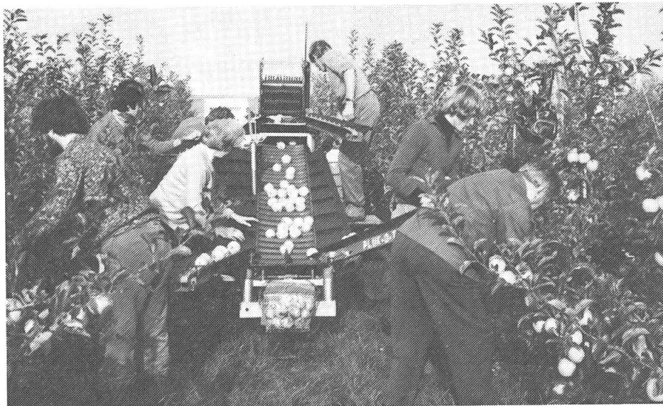
1 Die in Holland entwickelte Maschine für die Tafelapfelernte «Pluk-o-trak» steht speziell in Frankreich im Einsatz. Sie bringt vor allem eine Arbeitserleichterung, aber unter schweizerischen Verhältnissen mit zwei bis drei Erntegängen keine wesentliche Leistungssteigerung. Zudem müssen für eine genügende Auslastung gegen 20 ha Obstanlage geerntet werden können.
