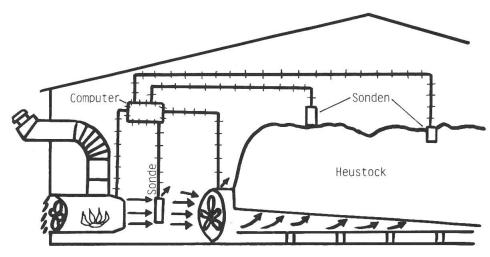
Abb. 1: Computergesteuerte Heutrocknung.
