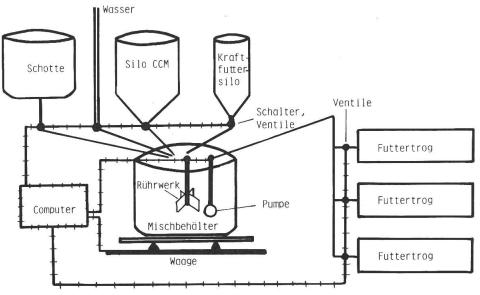
Abb. 2: Computergesteuertes Fütterungssystem Schweinemast.
