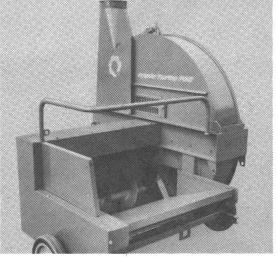
Für die schlagkräftige Silobefüllung sorgen die Siliergebläse EPPLE Turbo.
