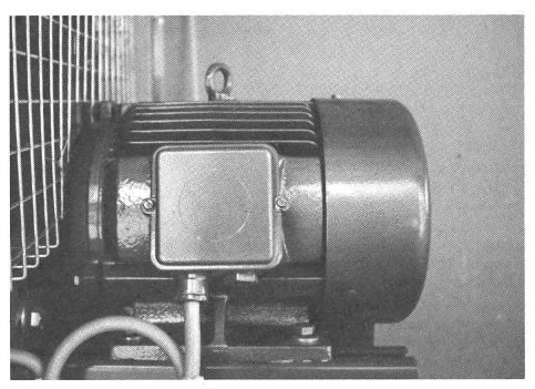
3 Drehstrommotor als Antrieb für ein Heubelüftungsgebläse.
