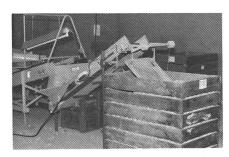
Abb. 20: Paloxenfüllgerät zu SAMRO KS 80.
