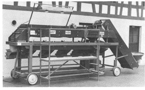
Abb. 6: COMPAS-LANCO AS 60. b: Ein Sieb für die Absonderung der minderwertigen Kleinknollen befindet sich vor dem Verlesetisch mit einer Ausschussbahn (nicht personalseitig). c: Die schockartige Erregung der Siebe erfolgt mittels einer Kurvenscheibe.
