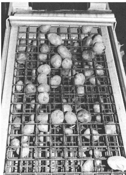
Abb. 16: Festgeklemt Knollen liessen sich bei den beiden Schwingsiebmaschinen meistens ohne Handeingriff durch Drehzahlerhöhung lösen (JABELMANN). Mit Gummi (im Bild) oder Plastik überzogene Siebe ermöglichten eine schonendere Knollenförderung bei allerdings stärkerer Verstopfungsneigung.
