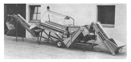
Abb. 7: SAMRO KS 80. Die Knollen vom Obersieb können entweder auf die mittlere (b) oder rechtsseitige Verlesebahn (c) abgelenkt werden. Im letzteren Fall ist die linke unbelegte Bahn für die Ablage der Ausschussknollen bestimmt. Diese Variante eignet sich – infolge Stauungen beim Obersiebauslauf – nicht für hohe Sortierleistungen.
