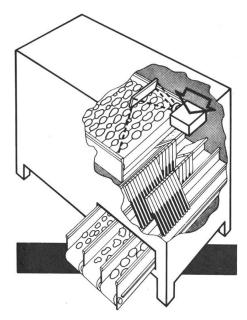
Abb. 4: Elektronisches Verlese- und Kalibriersystem (LOCTRONIC, GB).
