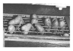
Abb. 15: Beim Schocksystem traten Verstopfungen fast nur auf den grösseren Sieben bei unförmigen Knollen auf (COMPAS).
