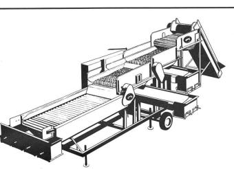
Abb. 2: Sortiermaschine mit zwei umlaufenden Maschensiebbändern für die Erstellung von insgesamt drei Knollenfraktionen (TONG, GB).
