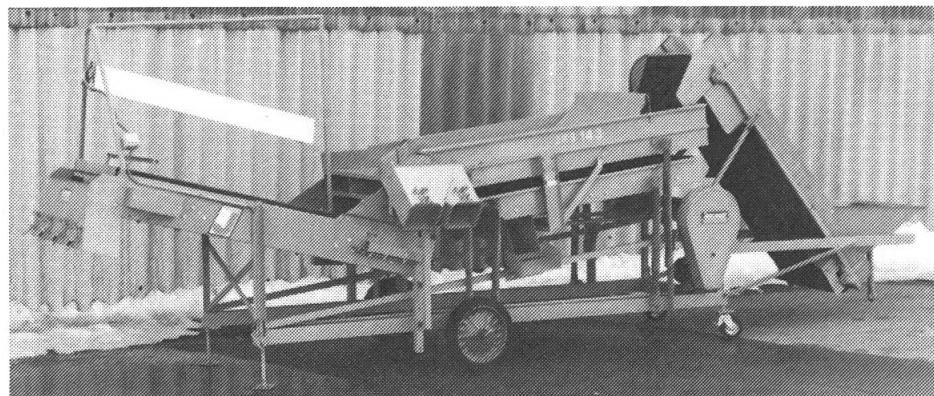
Abb. 8: JABELMANN JKS 143. b: Die Knollen der unteren Siebe gelangen auf die beiden Verlesebahnen. Der Obersiebüberlauf wird von einem links- oder rechtsseitig anzubringenden Absackstutzen aufgenommen.
