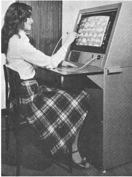
b) Die auszulesenden Knollen können örtlich getrennt an einem oder mehreren Farbbildschirmen (Tele-selector) elektronisch markiert werden.
