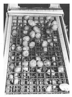
Abb. 16: Festgeklemmte Knollen liessen sich bei den beiden Schwingsiebmaschinen meistens ohne Handeingriff durch Drehzahlerhöhung lösen (JABELMANN). Mit Gummi (im Bild) oder Plastik überzogene Siebe ermöglichten eine schonendere Knollenförderung bei allerdings stärkerer Verstopfungsneigung.
