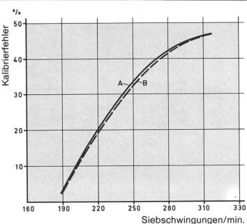
Abb. 13: Schwingsystem (SKALS): Einfluss der Siebfrequenz (Siebschwingungen/min.) und der Durchsatzleistung auf die Kalibriergenauigkeit.
