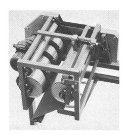
Abb. 3: Spiralwalzen-Kalibrieraggregat (KUSTER + VOGEL, CH). Der variable Abstand zwischen der Spiralund Glattwalze bildet den Sortierspalt. Für jede Fraktion ist ein solches Walzenpaar erforderlich.
