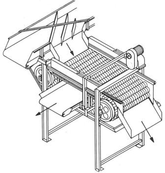
Abb. 1: Kalibriersystem mit umlaufenden Profilwalzen. Die spezielle Form der Walzen ermöglicht eine Quadratsortierung. Mit einem Aggregat können gleichzeitig mehrere Kalibrierfraktionen erstellt werden (BLASER CH, Maschine für bäuerliche Betriebe in Vorbereitung).
