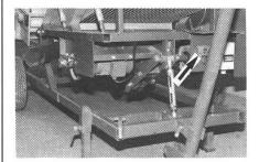
Abb. 18: Siebkastenunterbau von SAMRO KS 80: Gefährliche elektrische Installation (Pfeil). Der Rahmen und die Abstützung sind sehr stabil ausgelegt. Die Maschine kann ohne Mühe in Arbeits- und Transportstellung gebracht werden.
