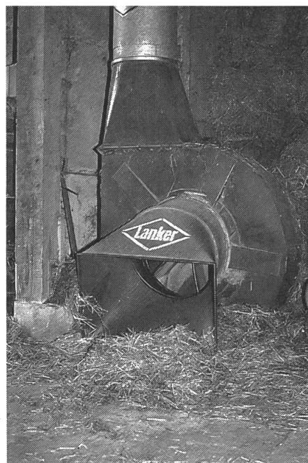
Das Ansauggebläse ist die am weitesten verbreitete Maschine für das Einlagern von Dürreheu, Welkheu und verschiedenen Silagen. Immer weniger Landwirte sind zur körperlich äusserst strengen Beschickungsarbeit bereit und suchen deshalb nach Ausweichmöglichkeiten.
