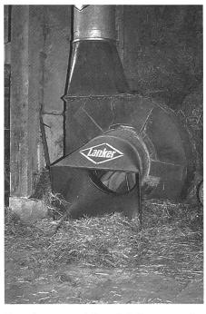
Das Ansauggebläse ist die am weitesten verbreitete Maschine für das Einlagern von Dürrheu, Welkheu und verschiedenen Silagen. Immer weniger Landwirte sind zur körperlich äusserst strengen Beschickungsarbeit bereit und suchen deshalb nach Ausweichmöglichkeiten.
