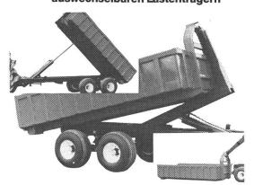
Mögliche Aufbauten als Mistzetter, Druckfass, Muldenkipper, Körnerwagen, Palette-Transporter, Holzwagen mit Kran, Viehtransporter.
