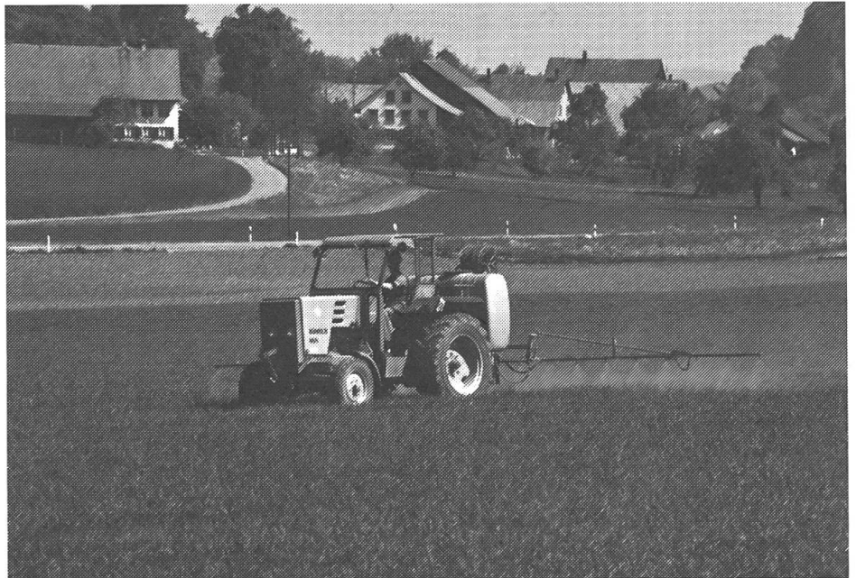
Anbauspritzen sind günstig in der Anschaffung. Wie wirken sich die breiten Reifen, die meistens fehlenden Halm- und Krautabweiser und die geringe Bodengefreiheit auf den Ertrag aus?
