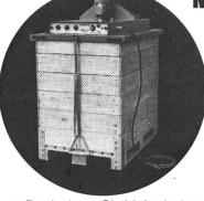
ist einsetzbar zum trocknen aller körnigen Produkte wie Weizen, Mais, Raps und praktisch aller Schüttgüter, sofern diese bei gefüllter Paloxe luftdurchlässig sind.
