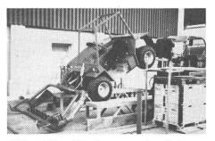
Abb. 7: Zur Bestimmung der Schwerpunkthöhe muss das Lot des Schwerpunktes bei Schräglage mit dem Lot bei ebener Lage verglichen werden.
