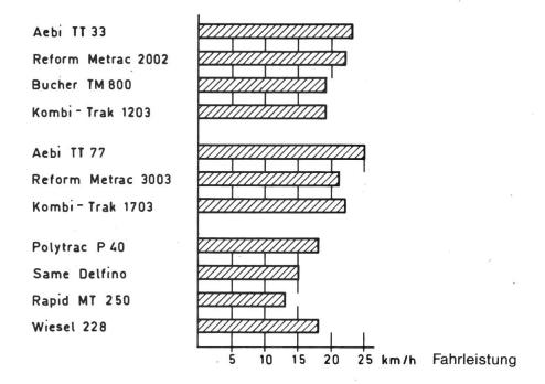
Abb. 3: Fahrleistung bei der Fahrt auf einer Bergstrasse. Höchstmögliche Geschwindigkeit bei 13% Steigung und einer Zusatzlast von total 400 kg.
