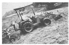
Abb. 6: Zweiachsmäher mit Mähwerk (Frontgewicht) und Dreipunktkreiselheuer, leicht abgehoben.
