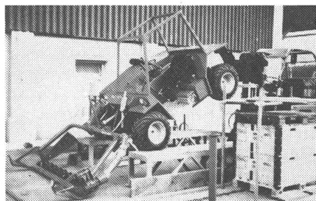
Abb. 7: Zur Bestimmung der Schwerpunkthöhe muss das Lot des Schwerpunktes bei Schräglage mit dem Lot bei ebener Lage verglichen werden.
