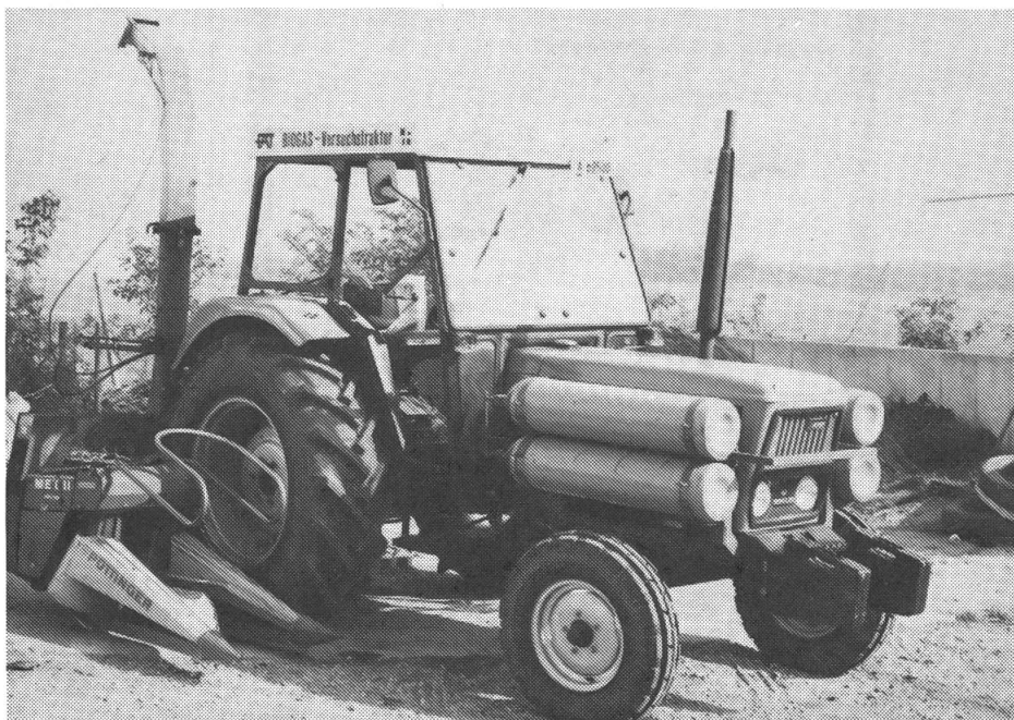
Abb. 1: Auf Biogasbetrieb umgerüsteter Versuchstraktor.
