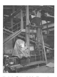
Nach der Rotte wird der Kompost zerkleinert und mit anderen Materialien (z.B. Torf) zum fertigen Substrat gemischt.
