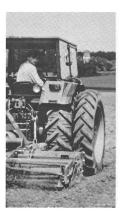
Wo immer möglich, sollten Doppelräder oder Gitterräder verwendet werden. Da viele Fronträder – besonders bei 2-Rad-getriebenen Traktoren – zu klein sind, sollte auch hier ein Umdenken bei den Konstrukteuren stattfinden.
