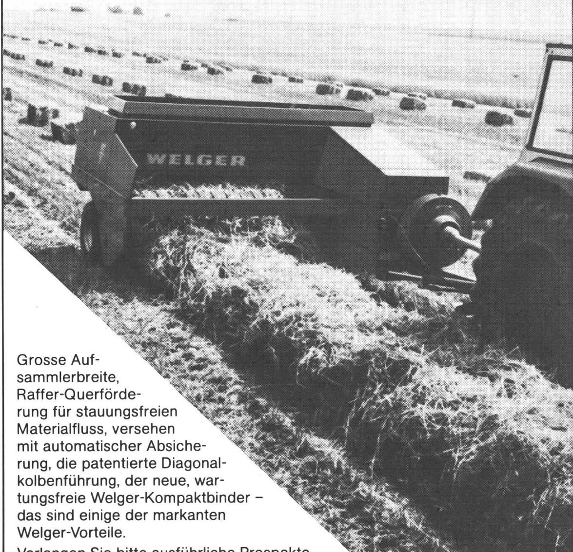
Grosse Aufsammlerbreite, Raffer-Querförderung für stauungsfreien Materialfluss, versehen mit automatischer Absicherung, die patentierte Diagonalkolbenführung, der neue, wartungsfreie Welger-Kompaktbinder – das sind einige der markanten Welger-Vorteile.
