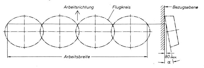
Abb. 1: Die Methode zur Bestimmung der Arbeitsbreite ist in der DIN-Norm 11 220 festgelegt.
