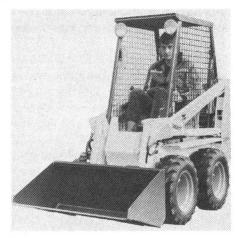
Als wertvolle Ergänzung zum breiten Programm gibt es jetzt einen Klein-Kompaktlader, der nur 107 cm breit ist und 860 kg wiegt. Der BOBCAT M 315 ist mit einem Kubota-Dieselmotor ausgerüstet der 9,6 kW (13 PS) leistet und zwei Fahrgeschwindigkeiten erlaubt.
