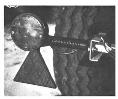
Geeignete Beleuchtungsanlage an einem Anhänger: Unter der Ladebrücke (geschützt gegen Auffahren) mit flexibler und fibrationshemmender Feder befestigt.
