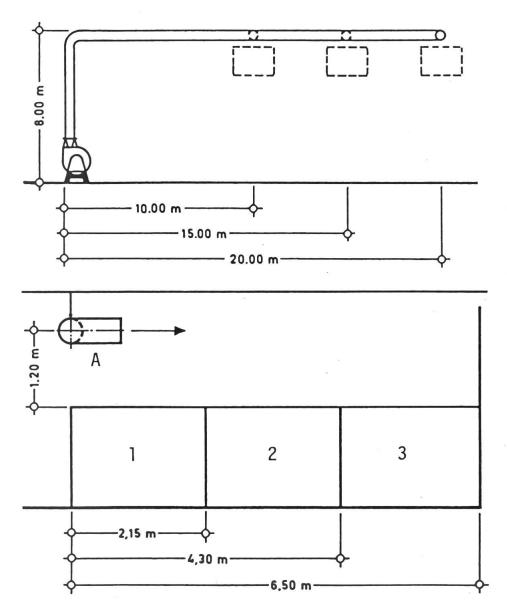
Abb. 1: A Schwenkbogen des Teleskopverteilers. 1, 2, 3 Auffangbehälter der Sektoren 1, 2 und 3. Schematische Darstellung der Förderleitung und der Versuchseinrichtung. Mit den drei Abteilungen der Auffangvorrichtung konnten gleichzeitig die Förderleistung und die Verteilung über den Stock gemessen werden.
