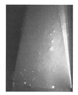
Abb. 2: All zu dünnes Blech erträgt keinen starken Steinbesatz im Futter, sonst kommt es bereits nach kurzer Einsatzdauer zu solchen Schäden.
