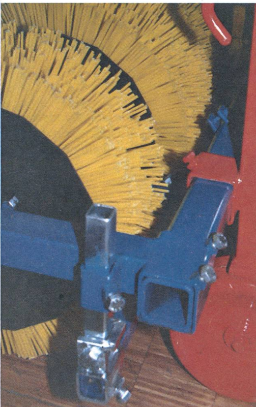
Neue Technik in der Unkrautbekämpfung: Hackbürste für Reihenkulturen.
