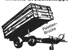
Einachs-Dreiseitenkipper, Typ Schweiz. Brücke: 4100 × 2004 × 500 + 500 mm. Fassungsvermögen: 8,2 m³. Bereifung: Michelin Stahlgürtelreifen 12 × 18 Pilote X Agricole. Beide Seitenwände pendelnd, 2,04 m für Palette, erhältlich auch 2,20 m
