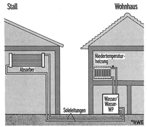
Abb. 2: Wärmepumpe mit Absorber im Stall (nach [2]).
