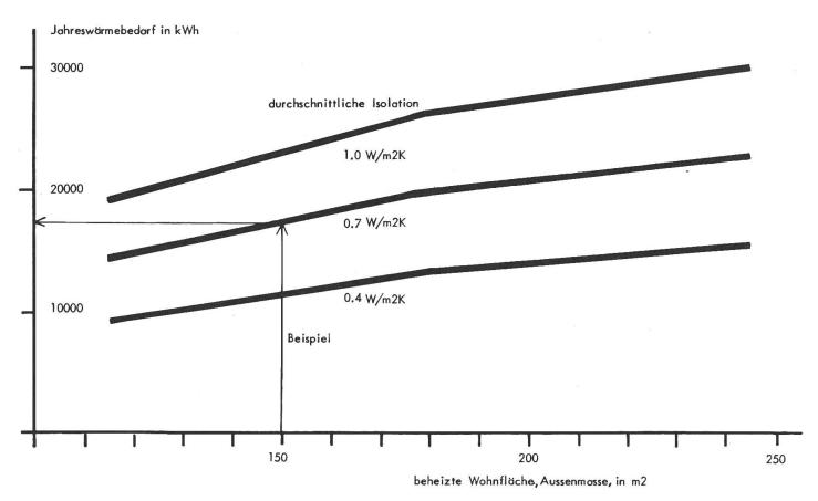
Abb. 5: Jahreswärmebedarf bei Einfamilienhäusern unterschiedlicher Grösse und Isolation.
