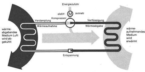
Abb. 1: Arbeitsweise einer Wärmepumpe (nach [1]).
