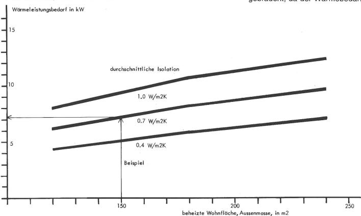
Abb. 4: Wärmeleistungsbedarf bei Einfamilienhäusern unterschiedlicher Grösse und Isolation.
