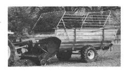
Es sind alle Vorkehrungen getroffen, dass der *Elch* im Hangeinsatz eine gute Figur macht: Die schlanke Deichsel erlaubt ein enges Wenden auch mit sehr breiter Traktor-Doppelbereifung; grosse Räder ergeben guten Seitenhalt und sicheres Bremsverhalten, wenn es rutschig ist; auf eine leichte und sichere Bedienung wurde grossen Wert gelegt, gerade weil dies im Hangeinsatz entscheidend ist.
