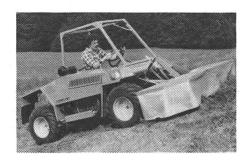
Die Zweiachsmaschine ist ausgerüstet mit 3-Zylinder-Dieselmotor, 30 PS, vollsynchronisiertem und reversierbarem Getriebe mit 8 Vorwärtsund 4 Rückwärtsgängen sowie hydrostatischer Lenkung.
