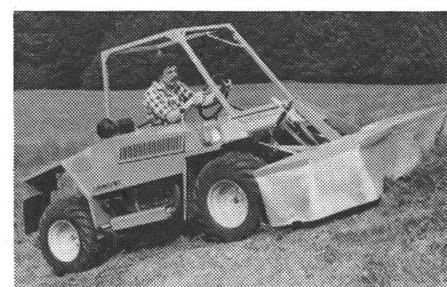
Die Zweiachsmaschine ist ausgerüstet mit 3-Zylinder-Dieselmotor, 30 PS, vollsynchronisiertem und reversierbarem Getriebe mit 8 Vorwärts- und 4 Rückwärtsgängen sowie hydrostatischer Lenkung.
