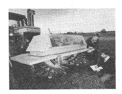
bau bestimmt. Der Fahrer des Schleppers sieht daher besser, was geschieht, und ausserdem kann eine zweite Maschine hinten mitgeführt werden, wobei die Arbeitsbreite von 2,1 m auf 4,2 m verdoppelt wird.
