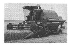
mit Schnittbreiten von 3,2-4,95 m mit vielen interessanten Konstruktionsmerkmalen wie schwimmende Tischführung, elektro-hydrostatische Rücklaufschaltung für den gesamten Einzug, Zusatzreinigung zur Unterstützung der Siebfunktion, Schneidewerkführung mit Höhenautomatik und Fernbedienung, hydrostatischer Fahrantrieb, elektronische Drehzahl- und Geschwindigkeitskontrolle, geräumige komfortable Kommandozentrale.
