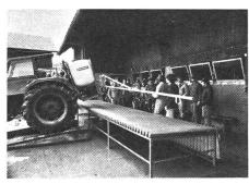
Nach den durchgeführten Revisionsund Kontrollarbeiten wird die Spritze auf dem «Dositest» ein letztes Mal geprüft . . .
