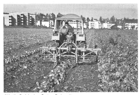
Abb. 4b: Dreiphasiges System: Rodegerät.
