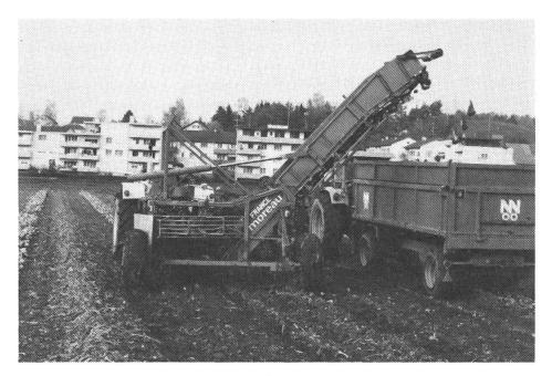
Abb. 4 c: Dreiphasiges System: Lader, Überlad auf parallel fahrenden Wagen.
