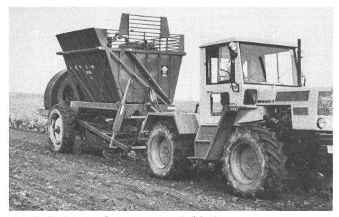
Abb. 2b: Zweiphasiges System: gezogener Ladebunker.
