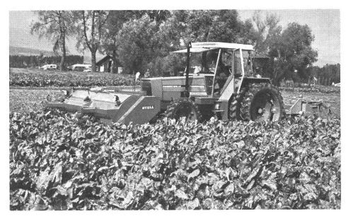
Abb. 3: Zweiphasiges System: Köpfer in Frontanbau und hinten angebautes Rodegerät (Lader siehe Abb. 4 c).
