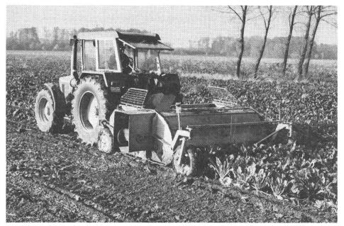
Abb. 2a: Zweiphasiges System: Köpfroder, gestossen von rückwärtsfahrendem Traktor.
