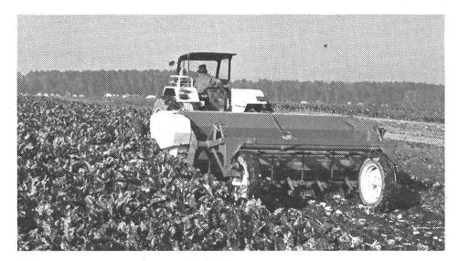
Abb. 4a: Dreiphasiges System: Köpfgerät.
