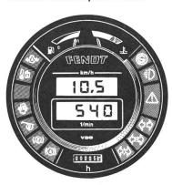
Im oberen Feld sehen Sie konstant die jeweilige Geschwindigkeit, die Sie fahren. Das untere Feld informiert Sie je nach Bedarf über die Zapfwellendrehzahl oder die Motordrehzahl. Die grosszügige Innenausstattung der Kabine trägt auch zur Reduzierung des Schallpegels auf 80 dBA nach OECD-Messbedingungen bei.
