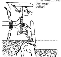
Quer- und Höhendurchlass. NON-STOP-Pflüge mit **abnehmendem** Druck nach oben beim Ausklinken (kein Gasdruckbehälter).
