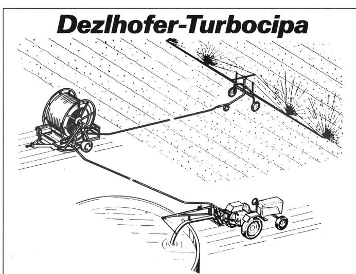
Die automatische Beregnungsmaschine für Wasser und Jauche (auch dickflüssig), Antrieb mit Turbine oder Benzinmotor, Beregnung mit Weitwurfregner oder Verteilbalken, verschiedene Gerätegrössen von 50–140 mm Rohrdurchmesser, Maschine 360° schwenkbar, hydraulisch verstellbar.
