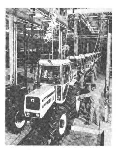
Auf rationellen Monatgestrassen werden die LAMBORGHINI-Traktoren zusammengebaut und mit modernsten Geräten die Qualität der Bauteile überprüft.
