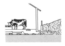
ne, die unter den Miststock mündet. Die Verbindung zwischen Mistplatz und Stall ist geschlossen und damit zugfrei. Alfa-Laval, Sursee
