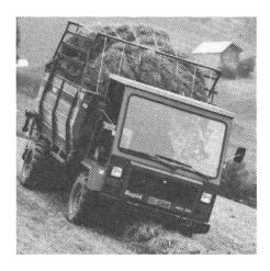
währleistet. Der neue Transporter mit einer Nutzlast bis 4000 kg und einem Radstand von 2,60 m ist leistungsfähig, wendig und ideal für wirtschaftlichen Dauereinsatz.
