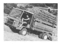
Hinterrradantrieb, Differentialsperren vorn und hinten sowie hohe Nutzlast. Dank der guten Motorleistung und der hohen Nutzlast ist der Aufbau des Aebi-Ladegerätes Ld 26 mit hydraulischem Kratzbodenantrieb und Pick-up-Aufzug und mit 14 m³ Fassungsvermögen möglich, was einmalig ist in der 30-PS-Transporter-Klasse.
