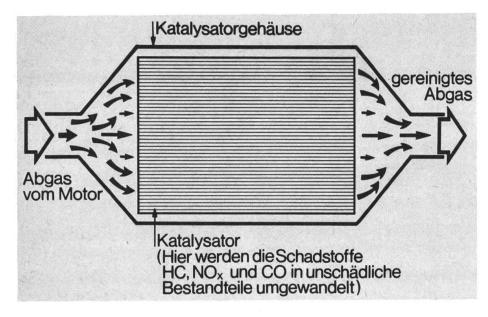
Abb. 1: Schnittzeichnung eines Autoabgas-Katalysators.
