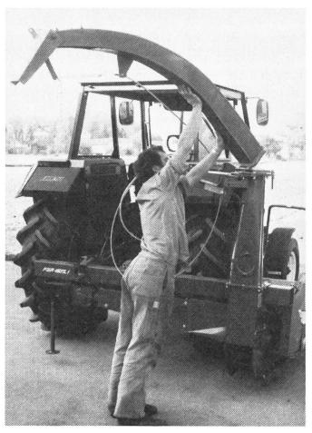
Abb. 5: Das Auswurfrohr sollt bei allen Maishäckslern auf halber Höhe abklappbar sein.
