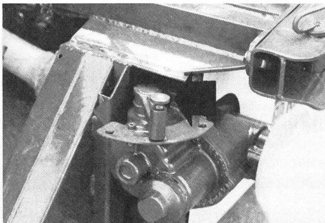
Abb. 4: Einfache Schnittlängenverstellung und Abschalten der Einzugsorgane durch ein Schaltgetriebe.
