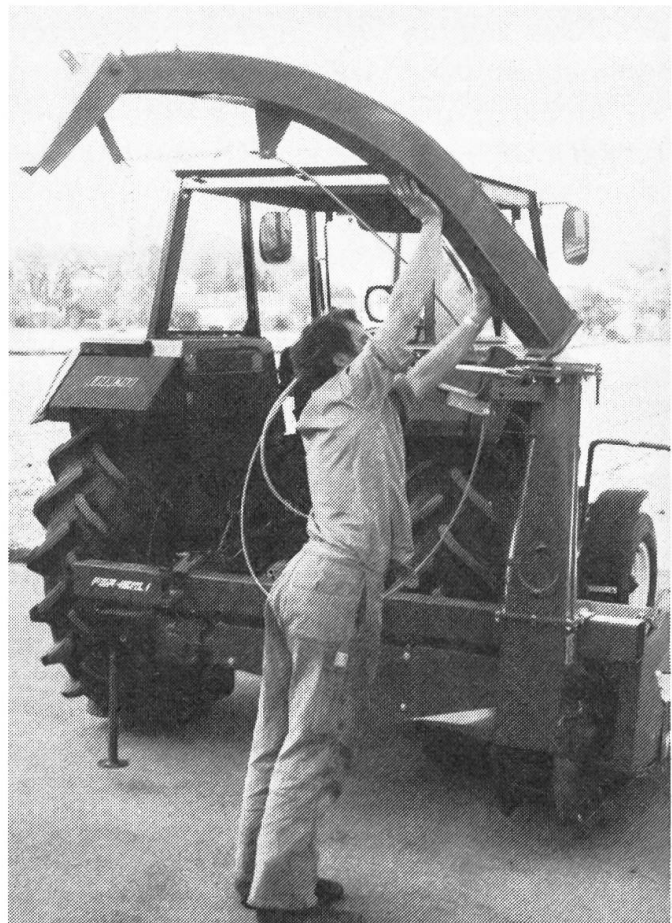
Abb. 5: Das Auswurfrohr soll bei allen Maishäckslern auf halber Höhe abklappbar sein.
